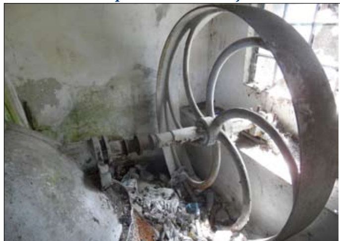
Koło pasowe przy wodnej turbinie dostarczającej energii do poruszania urządzeń młyna
